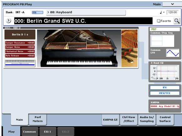
1. フロント・パネルにある [PROG] スイッチを押すとスイッチのLEDが点灯し、Programモードに入ります。
